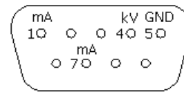
Рис.1. Цоколевка информационного разъема DB-9M
